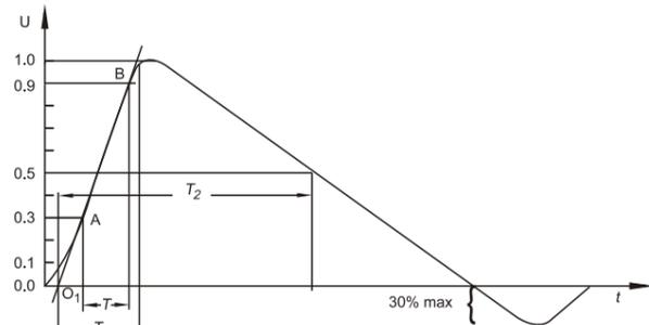
前缘时间:  $T_1 = 1.67 \times T = 1.2\mu s \pm 30\%$
