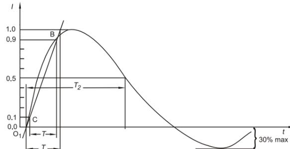
前缘时间:  $T_1 = 1.67 \times T = 8\mu s \pm 20\%$
