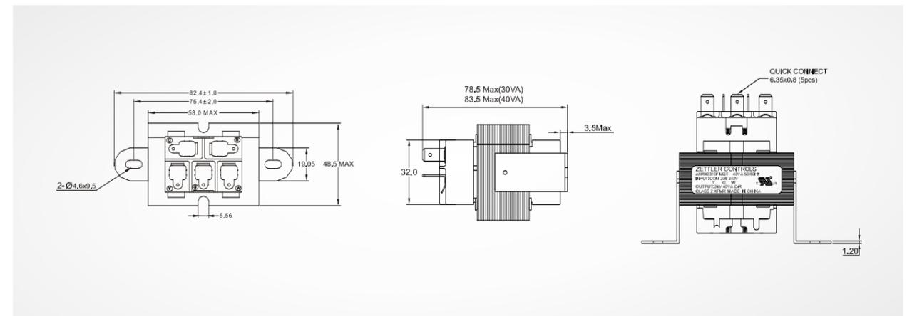
MECHANICAL SPECIFICATION [50VA] 尺寸图
